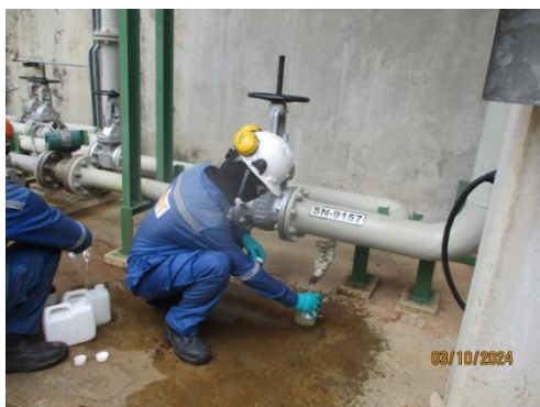
น้ำเสียจากกระบวนการผลิตก่อนบำบัดใน Equalization Tank (A)
